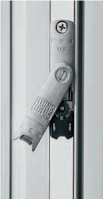
Trojfunkčný prvok s poistkou proti chybnému zaradeniu, nábehovou opierkou a zadržávačom balkónových dverí, ktorý drží krídlo bez uzamknutia v ráme.
