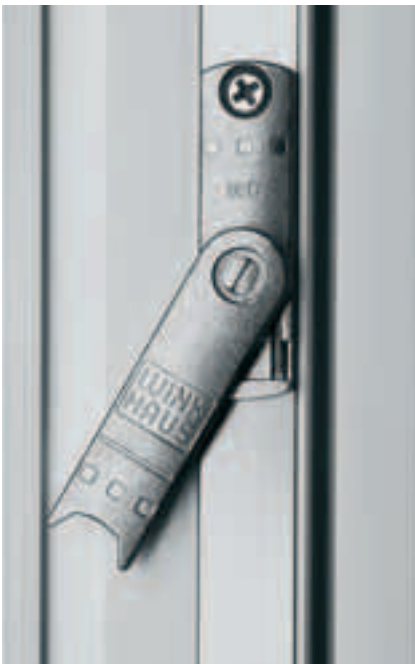
Dvojfunkčný prvok: Poistka proti chybnému zaradeniu zabráňuje chybnéj obsluhu okna a predchádza tým poškodeniu kovania a okna. Integrovaná nábehová opierka sa dodatočne stará o presný vstup krídla do rámu.
